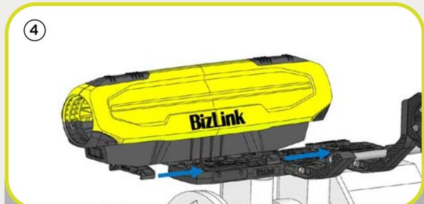
... und anschließend mit den Adapterverschlüssen in der gewünschten Position fixiert.
