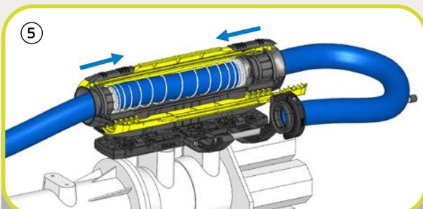
Das Schlauchpaket wird in die LSH Delta eingesetzt. Die LSH Delta wird über die Verschlusslaschen geschlossen.
